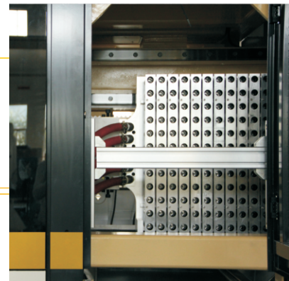
后冷却机械手 Post cooling take out robot
